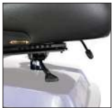
Sedile girevole, ribaltabile e regolabile in profondità
