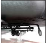
Sedile girevole, ribaltabile e regolabile in profondità
