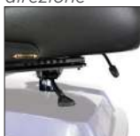
Sedile girevole, ribaltabile e regolabile in profondità
