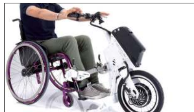
Porta indietro il corpo (D) e spingi il manubrio in avanti (E). Agganciato!
