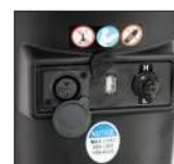
Selettore modalità di guida, presa per alimentazione e porta USB
