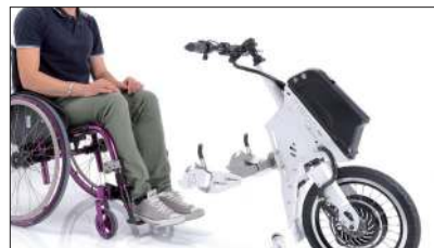
Spingi verso il basso e allontana il Tiboda® (I). Sganciato!
