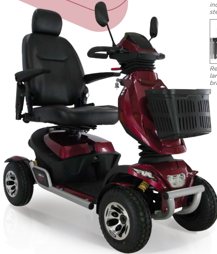
Sedile girevole, ribaltabile e regolabile in profondità
